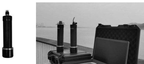
图 5 小型化水声通信机
